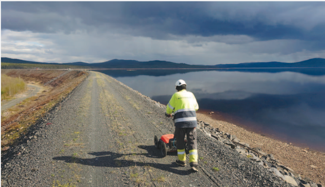
Core inspection in western Sweden. (Image courtesy of Suomen Maatutkapalvelu)
